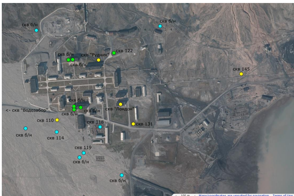
Рисунок 29 – Расположение расконсервированных скважин п. Пирамида. Желтый – скважины, оснащенные стационарными термокосами, зеленый – скважины с разовыми замерами температуры, синий – скважины с измерением щупом мощности сезонно-талого слоя
